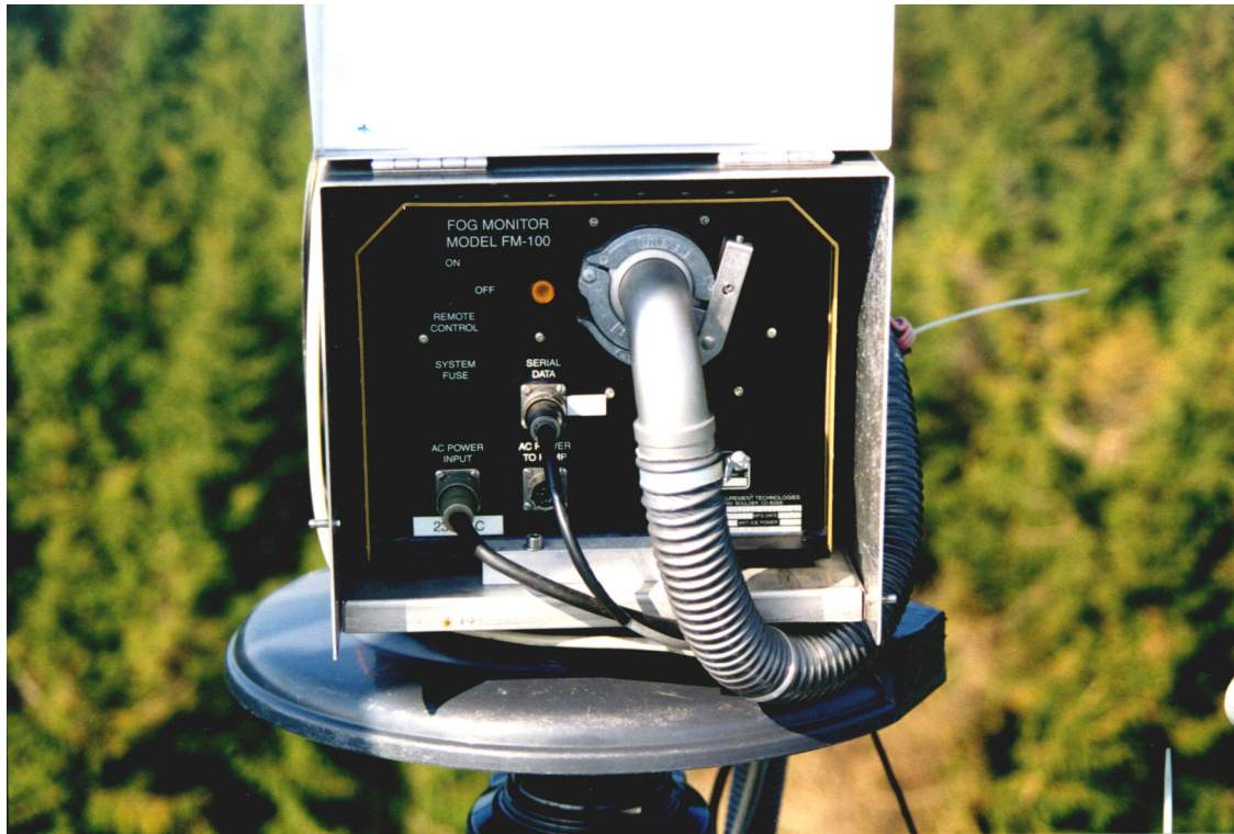
Abbildung 11: Das Nebeltropfenspektrometer FM-100 in der Ansicht von hinten im eingebauten Zustand. Quelle: eigenes Foto.
