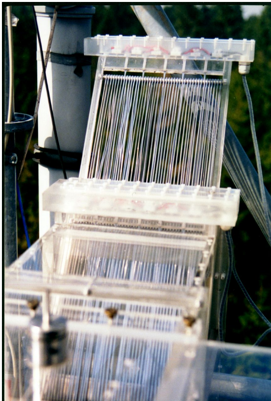
Abbildung 7: Die Nebelharfen. Eine der Harfen ist zum Reinigen herausgezogen.
